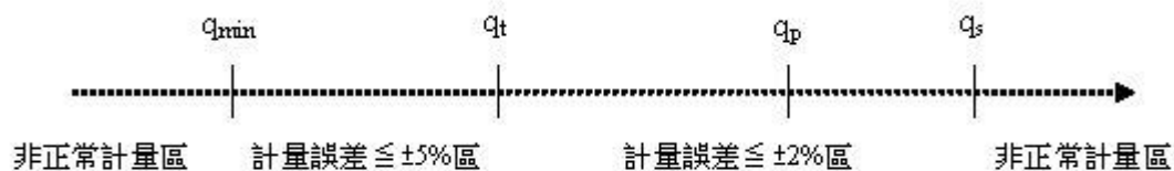
圖 4 水量計流量變化計量狀態示意圖
