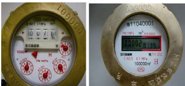
圖 5 機械式水量計與電子式水量計顯示面盤之比較
