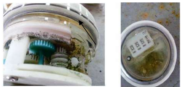
圖 6 機械表齒輪磨耗、斷裂圖及機械表積算盤面汙損
