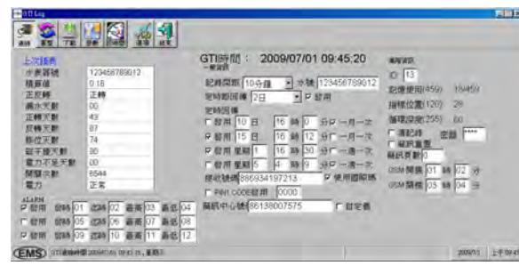
圖 3.21 傳訊記錄器可分時段設定上、下限，超過上下限即會主動回傳
