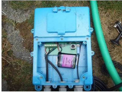
圖 4.5 傳訊介面連結壓力計與水量計
