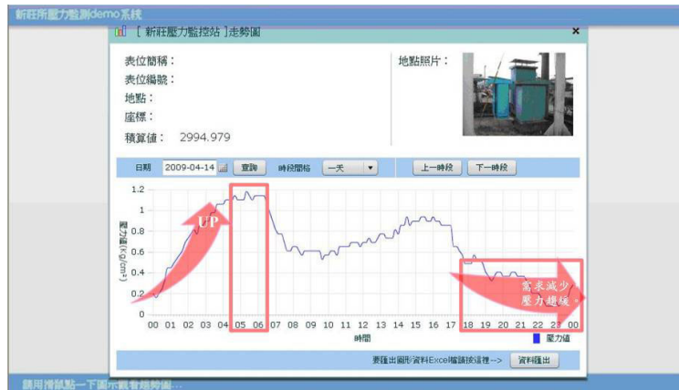
圖 5.1 一日壓力趨勢圖觀測
