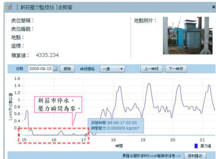
圖 5.3 因管線施工，十五日至十七日停水，後續壓力呈現週期性狀態
