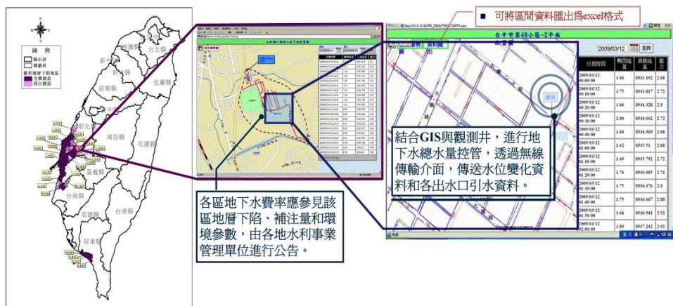
圖 4.2 結合 GIS 與經濟部水利署地層下陷查詢系統，進行地下水總水量管制之系統示意圖
