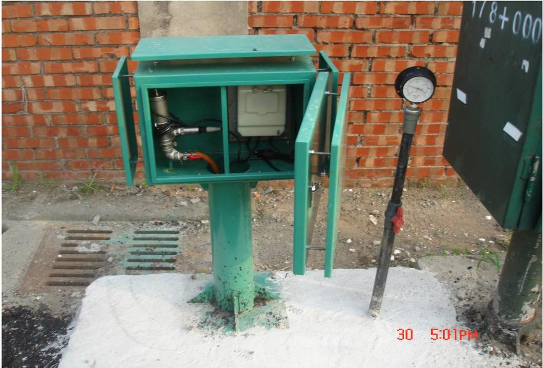
圖 3 傳訊記錄器現場圖 - 自備電源、IP67 防護等級
