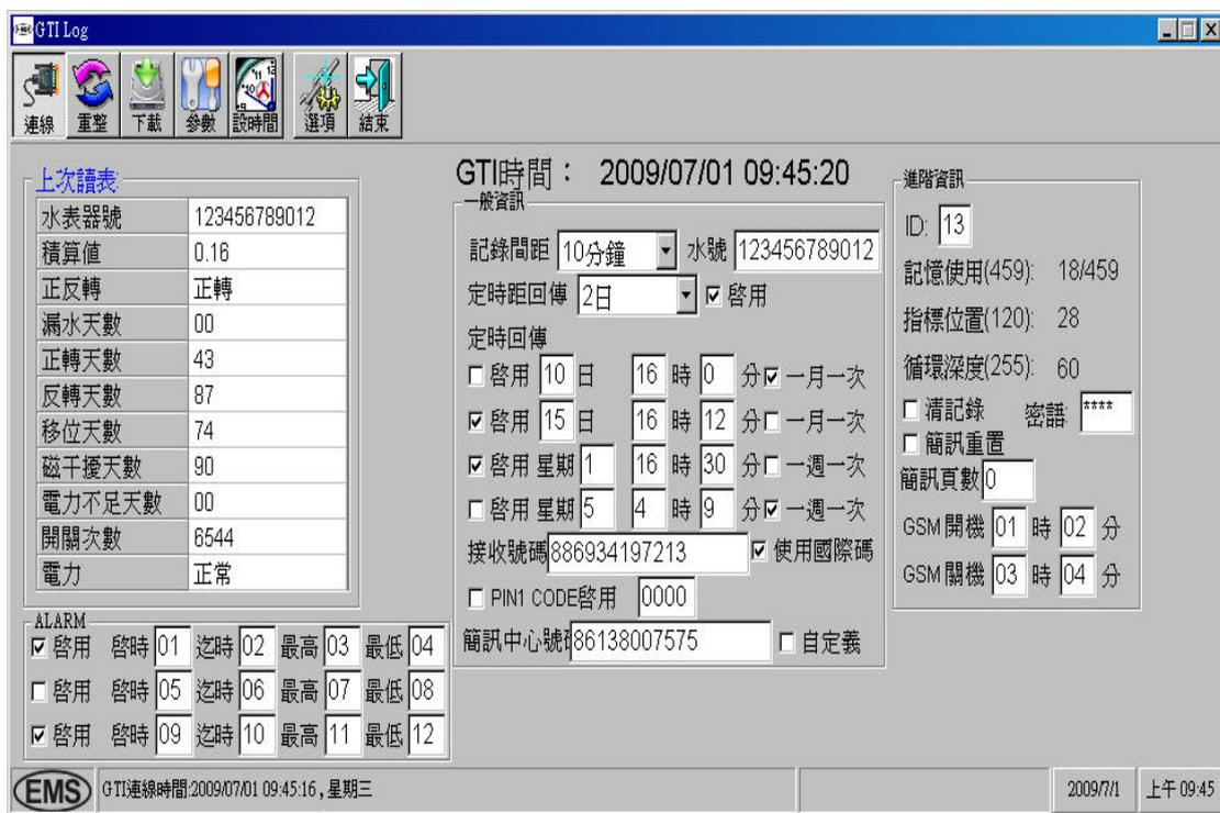
圖 21 傳訊記錄器可分時段設定上、下限，超過上下限即會主動回傳
